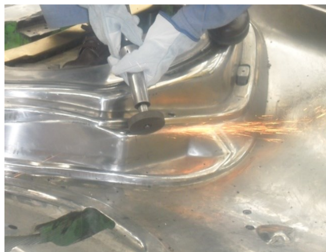
Fig.9 – Preparação da área a ser soldada. Fonte: Foto do acervo do autor.
