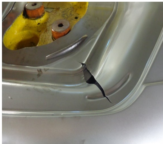
Fig. 4 - Ruptura no produto. Fonte: Foto do acervo do autor.
