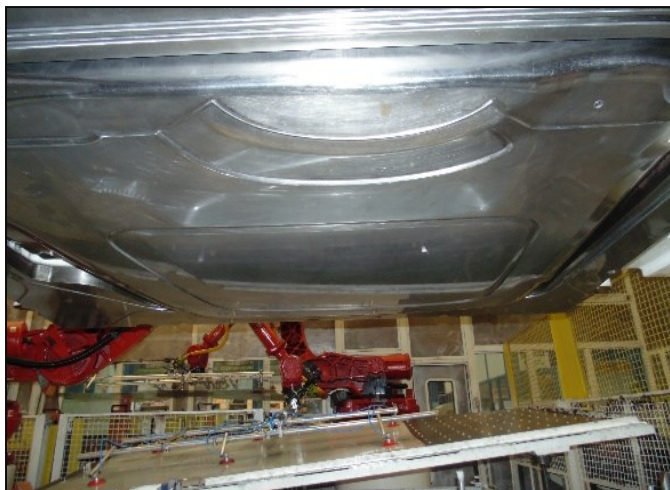
Fig. 2 Raios irregulares do punção. Fonte: Fotos de acervo do autor.
