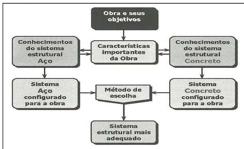
Figura 1: Escolha do sistema estrutural.
