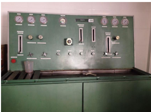
Figura 7: Bancada de teste hidráulico.
